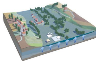
Inondation de nappe
